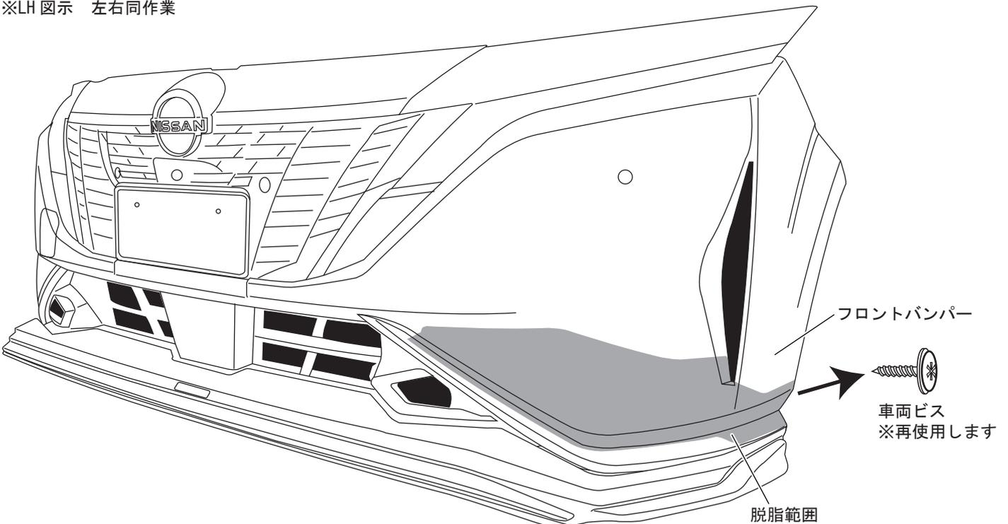
3. 下図を参照し、③フロントガーニッシュのホイールハウス折り返し部の穴位置に合わせて④樹脂ワッシャーを貼り付ける。(左右各1ヶ所) ※貼り付け部を脱脂すること。
