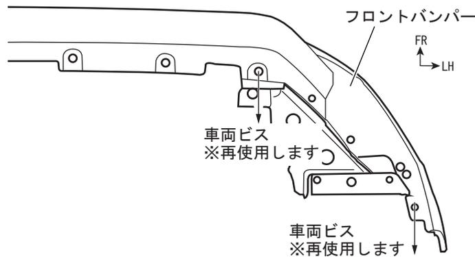
2. 下図を参照し、フロントバンパーの①フロントスポイラー貼り付け範囲をアルコール（IPA）で脱脂する。
