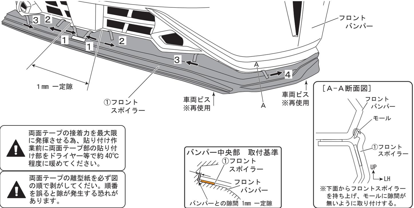
両面テープの接着力を最大限に発揮させる為、貼り付け作業前に両面テープ部の貼り付け部をドライヤー等で約40°C程度に暖めてください。
