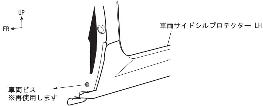
6. 下図を参照し、リヤ側ホイールハウス部の車両ビスを取り外す。(左右各1ヶ所)
