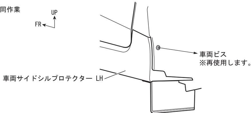
7. 下図を参照し、車両サイドシルプロテクターの①サイドスポイラー貼り付け範囲をアルコール（IPA）で脱脂する。
