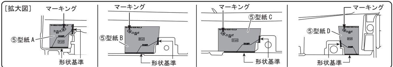
3. 下図を参照し、車両サイドシルプロテクター下面に径9mmのドリルで、キリでマーキングした位置に穴をあける。
