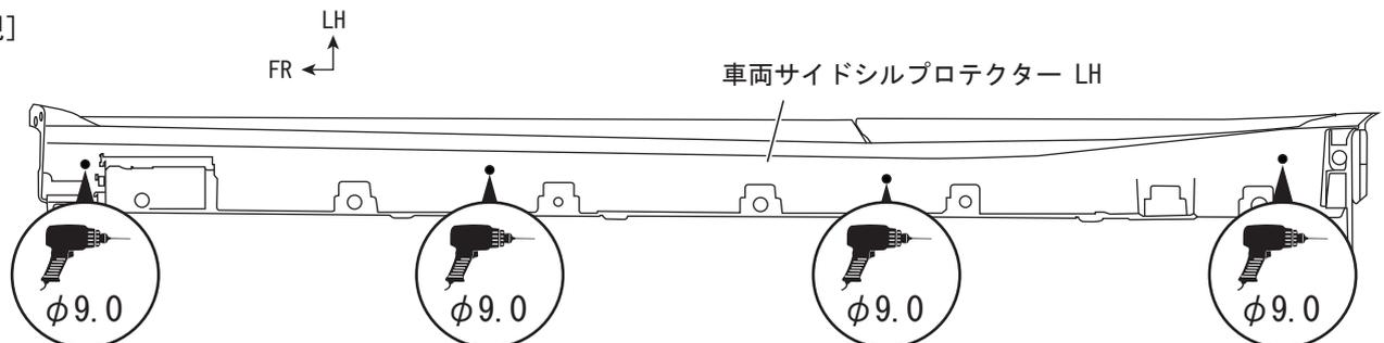
5. 下図を参照し、フロント側ホイールハウス部の車両ビスを取り外す。(左右各1ヶ所)
