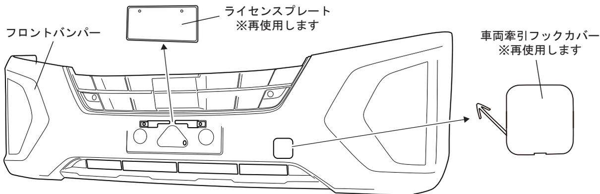
2. 下図を参照し、ライセンスプレート裏側と、フロントバンパー下面の車両ボルトを取り外す。
