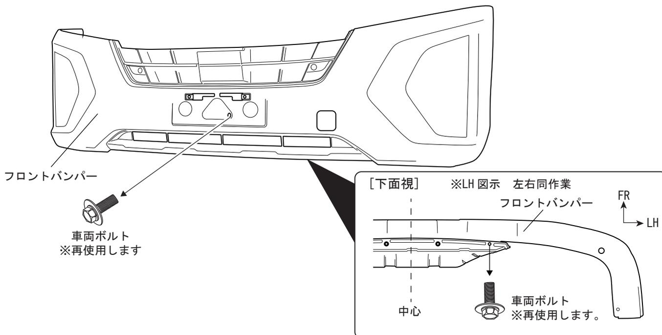
3. 下図を参照し、ライセンスプレート部の車両クリップナットを取り外す。
