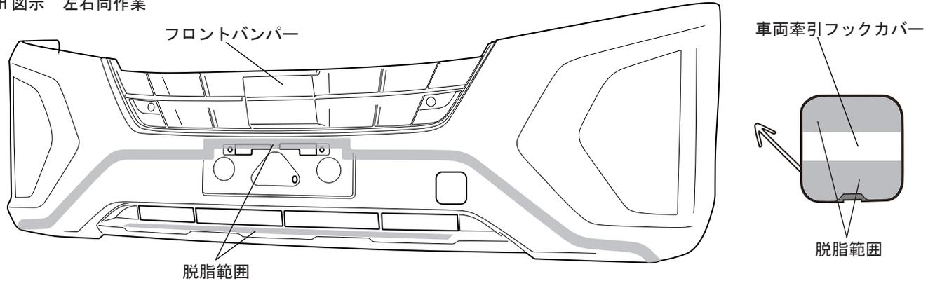
12. 下図を参照し、①フロントバンパーガーニッシュの上端をグリル下部のR止まりに高さ合わせてフロントバンパーに仮当てし、下面を車両ボルト、⑥クリップで仮固定する。ナンバー開口部のバランスを確認してガムテープ等で仮固定する。
