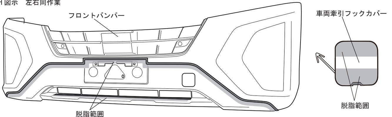
16. 下図を参照し、フロントバンパー、車両牽引カバーの両面テープ貼り付け部に⑧PAC プライマー K-500を塗布する。
