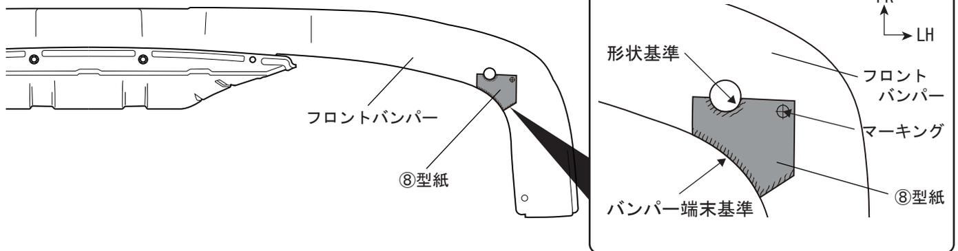
7. 下図を参照し、フロントバンパー下面の穴開け位置マーキングに合わせて穴を開ける。
