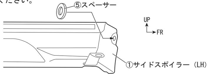
8. 下図を参照し、①サイドスポイラーを車両に仮当てし、下面を③クリップ小（左右各3ヶ所）、車両クリップ（左右各1ヶ所）、フロントホイールハウス部を④タッピングスクリュー（左右各1ヶ所）、リヤホイールハウス部を②クリップ大（左右各1ヶ所）で仮固定する。
