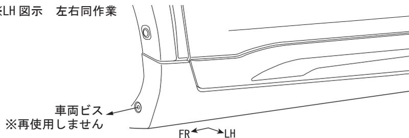
6. 下図を参照し、車両リヤスプラッシュガードの外側の車両クリップ（左右各1ヶ所）、下面の車両クリップを取り外す。（左右各1ヶ所）
