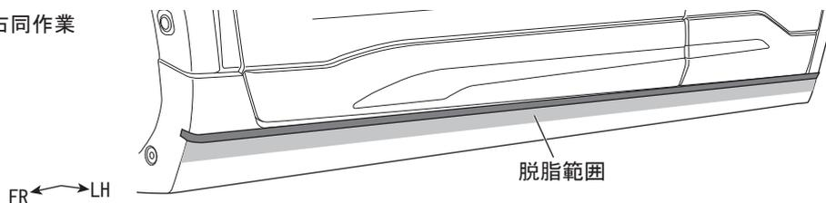
12. 下図を参照し、車両側面の両面テープ貼り付け部に⑦PAC プライマー K-500 を塗布する。
