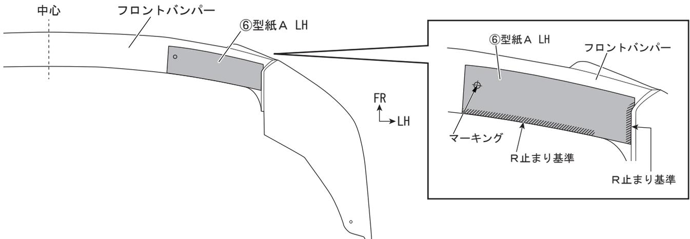
3. 下図を参照し、フロントバンパーのホイールハウス折り返し部に⑥型紙Bを貼り付ける。(左右各1ヶ所)
