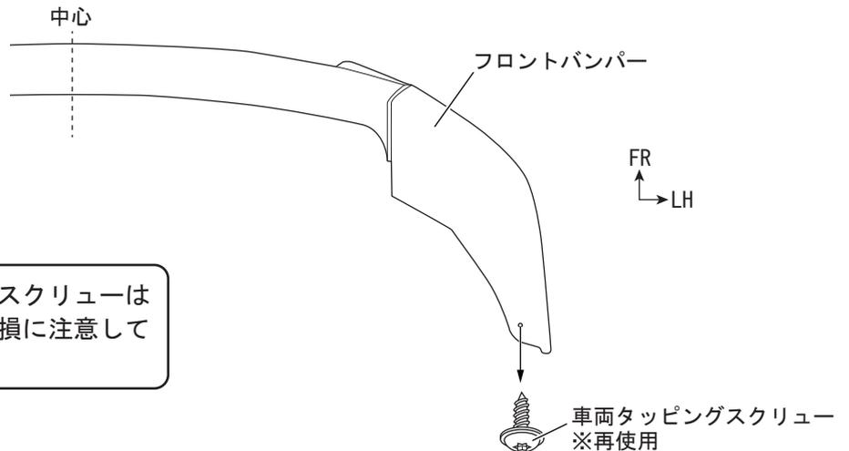
2. 下図を参照し、フロントバンパー下面に⑥型紙Aを貼り付ける。(左右各1ヶ所)
