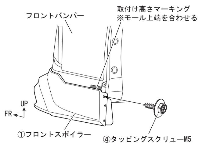
2. 各部の隙や取り付けバランスを確認して両面テープの離型紙を矢印の方向へ番号順に剥がし、圧着する。(左右各4ヶ所)
