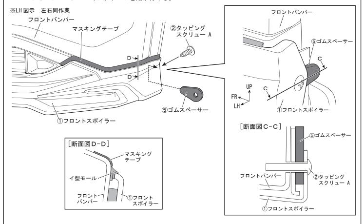
8. 下図を参照し、①フロントスポイラーのブラケット穴の中心に合わせて、キリでフロントバンパー下面に穴あけ位置をマーキングする。(左右各2ヶ所)
