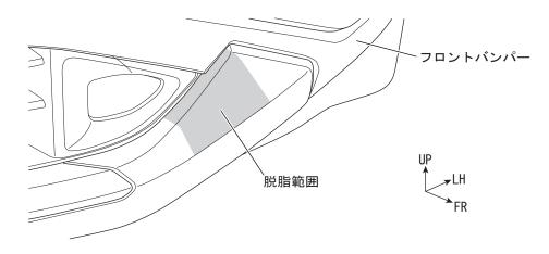
3. 下図を参照し、⑥ブラックアウトフィルムの中心をフロントバンパー部品の分割部に合わせ、フロントバンパーの 隙間に差し込みながら貼り付ける。(左右各 1 ヶ所)
