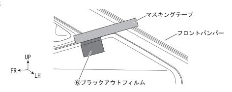
5. 下図を参照し、①フロントスポイラーのイ型モール上端をフロントバンパーのR止まりに合わせ(断面図 A-A参照)、L型モールと突き当てながら(断面図 B-B参照)仮当てし、①フロントスポイラーとフロントバンパーの隙間の車体色が⑥ブラックアウトフィルムで隠れていることを確認する。
