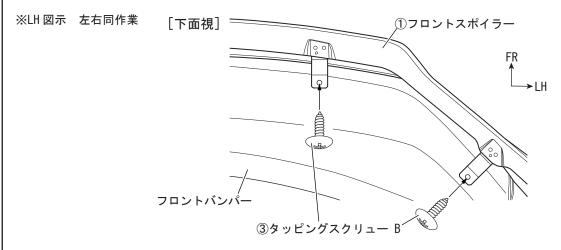
3. 下図を参照し、各部の隙や取り付けバランスを確認して両面テープの離型紙を左右交互に、番号順に矢印の方向へ剥がし、圧着する。
